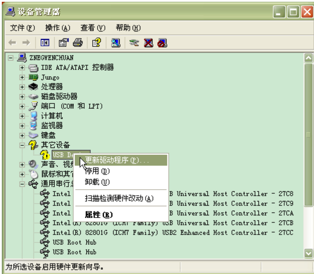
图 2.4 右键点击编程器的 USB 设备
